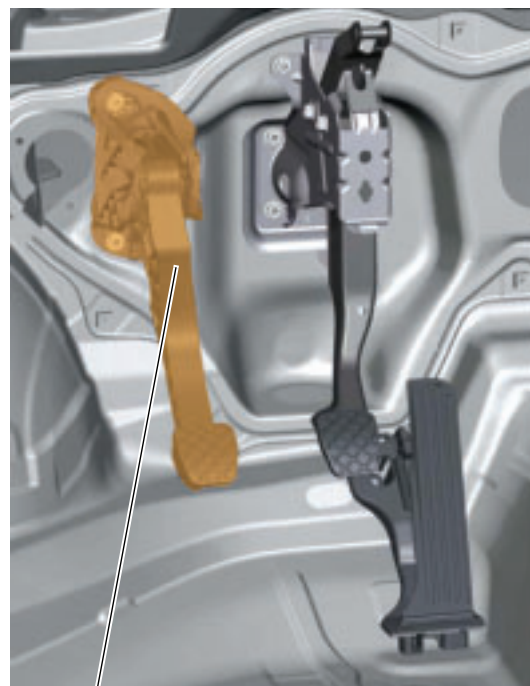
Pédale d'embrayage avec transmetteur de position de l'embrayage
